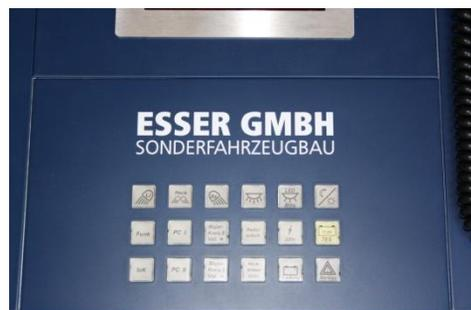
CAN-Bus System CM-100 Esser GmbH mit 18 schaltbaren Funktionen von den Kommunikationsarbeitsplätzen sowie 14 schaltbaren Funktionen vom Fahrerplatz
